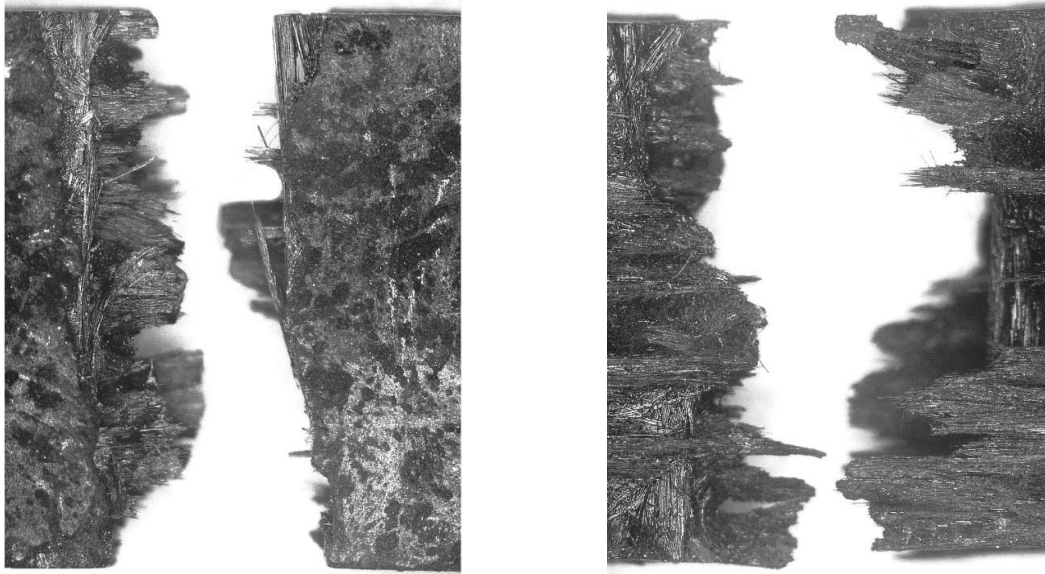
图 2.11 针刺复合材料宏观断口图片
